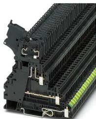
Morsetto portafusibili, tipo di fusibile: Vetro / ceramica / ..., tipo fusibile: G / 5 x 20, tensione nominale: 500 V, Corrente continua termica  $I_{th}$ : 30 A, tipo di connessione: Connessione a vite, Sezione di dimensionamento: 4 mm<sup>2</sup>, sezione: 0,14 mm<sup>2</sup>- 6 mm<sup>2</sup>, tipo di connessione: Connessione a vite, Sezione di dimensionamento: 4 mm<sup>2</sup>, sezione: 0,14 mm<sup>2</sup>- 6 mm<sup>2</sup>, tipo di montaggio: NS 35/7,5, NS 35/15, colore: nero
