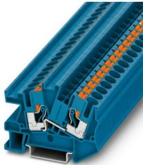
Morsetto per installazioni, tensione nominale: 800 V, corrente nominale: 41 A, Connessione Push-in, Sezione di dimensionamento: 6 mm<sup>2</sup>, sezione: 0,5 mm<sup>2</sup> - 10 mm<sup>2</sup>, tipo di montaggio: NS 35/7,5, NS 35/15, colore: blu
