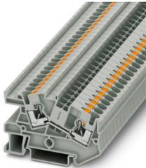
Morsetto per installazioni, tensione nominale: 800 V, corrente nominale: 32 A, Connessione Push-in, 1. piano, sezione: 0,2 mm<sup>2</sup> - 6 mm<sup>2</sup>, tipo di montaggio: NS 35/7,5, NS 35/15, colore: grigio
