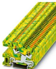
Morsetto per conduttore di terra per installazione, tensione nominale: 800 V, corrente nominale: 24 A, Connessione Push-in, 1. piano, Sezione di dimensionamento: 2,5 mm<sup>2</sup>, sezione: 0,14 mm<sup>2</sup> - 4 mm<sup>2</sup>, tipo di montaggio: NS 35/7,5, NS 35/15, colore: giallo-verde
