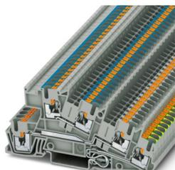
Morsetto per conduttore di terra per installazione, tensione nominale: 400 V, corrente nominale: 24 A, Connessione Push-in, 1., 2. e 3. piano, Sezione di dimensionamento: 2,5 mm<sup>2</sup>, sezione: 0,14 mm<sup>2</sup> - 4 mm<sup>2</sup>, tipo di montaggio: NS 35/7,5, NS 35/15, colore: grigio
