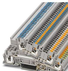
Morsetto per conduttore di terra per installazione, senza pulsante di azionamento sul lato alimentazione, tensione nominale: 400 V, corrente nominale: 24 A, Connessione Push-in, 1., 2. e 3. piano, Sezione di dimensionamento: 2,5 mm<sup>2</sup>, sezione: 0,14 mm<sup>2</sup> - 4 mm<sup>2</sup>, tipo di montaggio: NS 35/7,5, NS 35/15, colore: grigio
