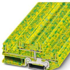
Morsetto a due piani per conduttori di terra, numero di connessioni: 4, tipo di connessione: Attacco connettore, 1. e 2. piano, sezione: 0,14 mm<sup>2</sup> - 1,5 mm<sup>2</sup>, tipo di montaggio: NS 35/7,5, NS 35/15, colore: giallo-verde
