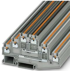
Morsetto a più piani, con ripartitore di potenziale, tensione nominale: 500 V, corrente nominale: 15 A, tipo di connessione: Connessione Push-in, 1. piano, Sezione di dimensionamento: 1,5 mm<sup>2</sup>, sezione: 0,14 mm<sup>2</sup> - 1,5 mm<sup>2</sup>, tipo di montaggio: NS 35/7,5, NS 35/15, colore: grigio
