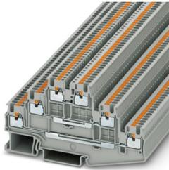
Morsetto a più piani, tensione nominale: 500 V, corrente nominale: 15 A, tipo di connessione: Connessione Push-in, 1. piano, Sezione di dimensionamento: 1,5 mm<sup>2</sup>, sezione: 0,14 mm<sup>2</sup> - 1,5 mm<sup>2</sup>, tipo di montaggio: NS 35/7,5, NS 35/15, colore: grigio
