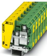
Morsetti comp. per conduttori terra, numero di connessioni: 2, numero poli: 1, tipo di connessione: Connessione a vite, Sezione di dimensionamento: 70 mm<sup>2</sup>, sezione: 16 mm<sup>2</sup> - 95 mm<sup>2</sup>, tipo di fissaggio: Piedino PE con vite di fissaggio M6, tipo di montaggio: NS 35/7,5, NS 35/15, NS 35/15-2,3, NS 32, colore: giallo-verde
