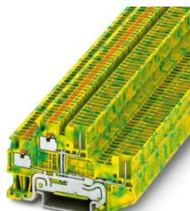
Morsetto a due piani per conduttori di terra, numero di connessioni: 4, tipo di connessione: Push-in / attacco connettore, 1. e 2. piano, sezione: 0,14 mm<sup>2</sup> - 1,5 mm<sup>2</sup>, tipo di montaggio: NS 35/7,5, NS 35/15, colore: giallo/verde
