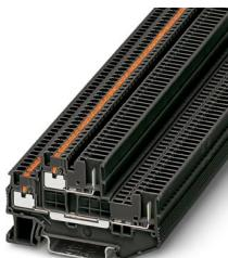
Morsetto a due piani, Corrente e tensione sono determinate dalla spina impiegata., tensione nominale: 500 V, corrente nominale: 16 A, tipo di connessione: Push-in / attacco connettore, 1. e 2. piano, Sezione di dimensionamento: 1,5 mm<sup>2</sup>, sezione: 0,14 mm<sup>2</sup> - 1,5 mm<sup>2</sup>, tipo di montaggio: NS 35/7,5, NS 35/15, colore: nero
