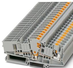
Morsetto sezionatore per conv. misura, tensione nominale: 500 V, corrente nominale: 30 A, tipo di connessione: Connessione Push-in, 1. piano, Sezione di dimensionamento: 6 mm<sup>2</sup>, sezione: 0,5 mm<sup>2</sup> - 10 mm<sup>2</sup>, colore: grigio
