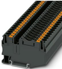
Morsetto portafusibili, tipo di fusibile: Piatta, tipo fusibile: Tipo C / max. 2,2 W, tensione nominale: 400 V, corrente nominale: 25 A, tipo di connessione: Connessione Push-in, Sezione di dimensionamento: 6 mm<sup>2</sup>, sezione: 0,5 mm<sup>2</sup>- 10 mm<sup>2</sup>, tipo di montaggio: NS 35/7,5, NS 35/15, colore: nero
