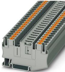
Morsetto sezionatore, Corrente e tensione sono determinate dalla spina impiegata., tensione nominale: 500 V, corrente nominale: 20 A, tipo di connessione: Connessione Push-in, Sezione di dimensionamento: 6 mm<sup>2</sup>, sezione: 0,5 mm<sup>2</sup> - 10 mm<sup>2</sup>, montaggio: NS 35/7,5, NS 35/15, colore: grigio
