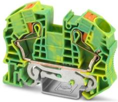
Morsetti comp. per conduttori terra, numero di connessioni: 2, tipo di connessione: Connessione Push-in, Sezione di dimensionamento: 16 mm<sup>2</sup>, sezione: 0,5 mm<sup>2</sup> - 25 mm<sup>2</sup>, tipo di montaggio: NS 35/7,5, NS 35/15, colore: giallo-verde
