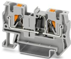
Componente morsetto componibile, La corrente massima è determinata dal diodo. Integrato: diodo 1N 5408, tensione di blocco: 1000 V, corrente limite permanente: 1,5 A, con diodo integrato 1N5408, corrente nominale: 1,5 A, tipo di connessione: Connessione Push-in, Sezione di dimensionamento: 4 mm<sup>2</sup>, sezione: 0,2 mm<sup>2</sup> - 6 mm<sup>2</sup>, montaggio: NS 35/7,5, NS 35/15, colore: grigio
