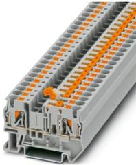
Morsetto con sezionatore a coltello, tensione nominale: 500 V, corrente nominale: 20 A, tipo di connessione: Connessione Push-in, Sezione di dimensionamento: 4 mm<sup>2</sup>, sezione: 0,2 mm<sup>2</sup> - 6 mm<sup>2</sup>, montaggio: NS 35/7,5, NS 35/15, colore: grigio
