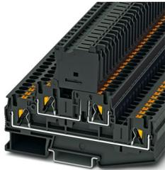
Morsetto portafusibili, tipo di fusibile: Vetro / ceramica / ..., tipo fusibile: G / 5 x 20, tensione nominale: 24 V, corrente nominale: 28 A, tipo di connessione: Connessione Push-in, 1. piano, Sezione di dimensionamento: 4 mm<sup>2</sup>, sezione: 0,2 mm<sup>2</sup>- 6 mm<sup>2</sup>, tipo di connessione: Connessione Push-in, 2. piano, Sezione di dimensionamento: 4 mm<sup>2</sup>, sezione: 0,2 mm<sup>2</sup>- 6 mm<sup>2</sup>, tipo di montaggio: NS 35/7,5, NS 35/15, colore: nero
