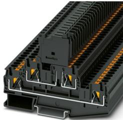
Morsetto portafusibili, tipo di fusibile: Vetro / ceramica / ..., tipo fusibile: G / 5 x 20, tensione nominale: 500 V, corrente nominale: 28 A, tipo di connessione: Connessione Push-in, 1. piano, Sezione di dimensionamento: 4 mm<sup>2</sup>, sezione: 0,2 mm<sup>2</sup>- 6 mm<sup>2</sup>, tipo di connessione: Connessione Push-in, 2. piano, Sezione di dimensionamento: 4 mm<sup>2</sup>, sezione: 0,2 mm<sup>2</sup>- 6 mm<sup>2</sup>, tipo di montaggio: NS 35/7,5, NS 35/15, colore: nero
