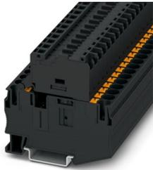
Morsetto portafusibili, tipo di fusibile: Vetro / ceramica / ..., tipo fusibile: G / 6,3 x 32, tensione nominale: 24 V, corrente nominale: 10 A, tipo di connessione: Connessione Push-in, Sezione di dimensionamento: 6 mm<sup>2</sup>, sezione: 0,5 mm<sup>2</sup>- 10 mm<sup>2</sup>, tipo di montaggio: NS 35/7,5, NS 35/15, colore: nero
