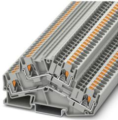
Morsetto a due piani, tensione nominale: 800 V, corrente nominale: 28 A, tipo di connessione: Connessione Push-in, 1. e 2. piano, Sezione di dimensionamento: 4 mm<sup>2</sup>, sezione: 0,2 mm<sup>2</sup> - 6 mm<sup>2</sup>, tipo di montaggio: NS 35/7,5, NS 35/15, colore: grigio
