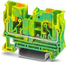
Morsetti comp. per conduttori terra, numero di connessioni: 2, numero poli: 1, tipo di connessione: Connessione Push-in, sezione: 0,5 mm<sup>2</sup> - 10 mm<sup>2</sup>, tipo di montaggio: NS 35/7,5, NS 35/15, colore: giallo-verde
