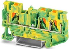
Morsetti comp. per conduttori terra, numero di connessioni: 3, tipo di connessione: Connessione Push-in, Sezione di dimensionamento: 4 mm<sup>2</sup>, sezione: 0,2 mm<sup>2</sup> - 6 mm<sup>2</sup>, tipo di montaggio: NS 35/7,5, NS 35/15, colore: giallo-verde
