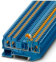
Morsetto con sezionatore a coltello, tensione nominale: 400 V, corrente nominale: 20 A, tipo di connessione: Connessione Push-in, Sezione di dimensionamento: 2,5 mm<sup>2</sup>, sezione: 0,14 mm<sup>2</sup> - 4 mm<sup>2</sup>, montaggio: NS 35/7,5, NS 35/15, colore: blu
