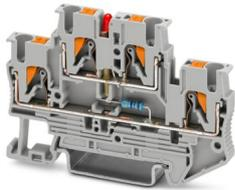
Morsetto a due piani, La tensione di esercizio è determinata dalla versione di indicatore luminoso. Caratteristiche LED 30 V DC ... 60 V DC, 0,8 mA ... 1,8 mA, tensione nominale: 500 V, corrente nominale: 20 A, 1. e 2. piano, tipo di connessione: Connessione Push-in, Sezione di dimensionamento: 2,5 mm<sup>2</sup>, sezione: 0,14 mm<sup>2</sup> - 4 mm<sup>2</sup>, montaggio: NS 35/7,5, NS 35/15, colore: grigio
