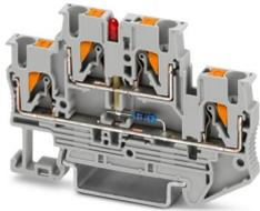
Morsetto a due piani, La tensione di esercizio è determinata dalla versione di indicatore luminoso. Caratteristiche LED 12 V DC ... 30 V DC, 0,7 mA ... 2,4 mA, tensione nominale: 500 V, corrente nominale: 20 A, tipo di connessione: Connessione Push-in, Sezione di dimensionamento: 2,5 mm<sup>2</sup>, sezione: 0,14 mm<sup>2</sup> - 4 mm<sup>2</sup>, montaggio: NS 35/7,5, NS 35/15, colore: grigio
