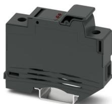
Portafusibili, tipo di fusibile: Vetro / ceramica / ..., tipo fusibile: gPV 10,3 x 38 mm secondo 60269-6, tensione nominale: 1000 V DC, corrente nominale: 30 A, tipo di connessione: Connessione a vite, Sezione di dimensionamento: 16 mm<sup>2</sup>, sezione: 0,75 mm<sup>2</sup>- 25 mm<sup>2</sup>, tipo di montaggio: NS 35/7,5, NS 35/15, colore: nero
