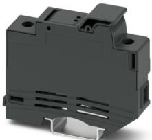
Portafusibili, tipo di fusibile: Vetro / ceramica / ..., tipo fusibile: gPV 10,3 x 38 mm secondo 60269-6, tensione nominale: 1000 V DC, corrente nominale: 30 A, tipo di connessione: Connessione a vite, Sezione di dimensionamento: 16 mm<sup>2</sup>, sezione: 1,5 mm<sup>2</sup>- 25 mm<sup>2</sup>, tipo di montaggio: NS 35/7,5, NS 35/15, colore: nero
