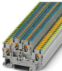
Morsetto a due piani per conduttori di terra, tensione nominale: 500 V, corrente nominale: 24 A, tipo di connessione: Connessione Push-in, 1. e 2. piano, Sezione di dimensionamento: 2,5 mm<sup>2</sup>, sezione: 0,14 mm<sup>2</sup> - 4 mm<sup>2</sup>, tipo di montaggio: NS 35/7,5, NS 35/15, colore: grigio
