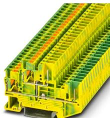
Morsetto a due piani per conduttori di terra, numero di connessioni: 4, tipo di connessione: Push-in / attacco connettore, 1. e 2. piano, sezione: 0,14 mm<sup>2</sup> - 4 mm<sup>2</sup>, tipo di montaggio: NS 35/7,5, NS 35/15, colore: giallo-verde
