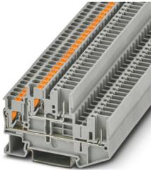
Morsetto a due piani, Corrente e tensione sono determinate dalla spina impiegata., tensione nominale: 500 V, corrente nominale: 22 A, tipo di connessione: Push-in / attacco connettore, Sezione di dimensionamento: 2,5 mm<sup>2</sup>, sezione: 0,14 mm<sup>2</sup> - 4 mm<sup>2</sup>, tipo di montaggio: NS 35/7,5, NS 35/15, colore: grigio
