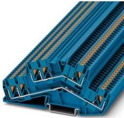
Morsetto a due piani, tensione nominale: 800 V, corrente nominale: 20 A, tipo di connessione: Connessione Push-in, 1. e 2. piano, Sezione di dimensionamento: 2,5 mm<sup>2</sup>, sezione: 0,14 mm<sup>2</sup> - 4 mm<sup>2</sup>, tipo di montaggio: NS 35/7,5, NS 35/15, colore: blu
