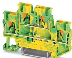
Morsetto a due piani per conduttori di terra, numero di connessioni: 4, tipo di connessione: Connessione Push-in, 1. e 2. piano, Sezione di dimensionamento: 2,5 mm<sup>2</sup>, sezione: 0,14 mm<sup>2</sup> - 4 mm<sup>2</sup>, tipo di montaggio: NS 35/7,5, NS 35/15, colore: giallo-verde
