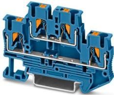
Morsetto a due piani, tensione nominale: 500 V, corrente nominale: 22 A, tipo di connessione: Connessione Push-in, 1. e 2. piano, Sezione di dimensionamento: 2,5 mm<sup>2</sup>, sezione: 0,14 mm<sup>2</sup> - 4 mm<sup>2</sup>, tipo di montaggio: NS 35/7,5, NS 35/15, colore: blu
