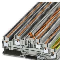
Morsetto per conduttore di terra per installazione, tensione nominale: 400 V, corrente nominale: 22 A, Connessione Push-in, Sezione di dimensionamento: 2,5 mm<sup>2</sup>, sezione: 0,14 mm<sup>2</sup> - 4 mm<sup>2</sup>, Connessione Push-in, Sezione di dimensionamento: 2,5 mm<sup>2</sup>, sezione: 0,14 mm<sup>2</sup> - 4 mm<sup>2</sup>, tipo di montaggio: NS 35/7,5, NS 35/15, colore: grigio
