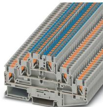
Morsetto a più piani, tensione nominale: 500 V, corrente nominale: 20 A, tipo di connessione: Connessione Push-in, 1., 2. e 3. piano, Sezione di dimensionamento: 2,5 mm<sup>2</sup>, sezione: 0,14 mm<sup>2</sup> - 4 mm<sup>2</sup>, tipo di montaggio: NS 35/7,5, NS 35/15, colore: grigio
