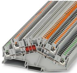
Morsetto sezionatore, Corrente e tensione sono determinate dalla spina impiegata., A due piani con profilo obliquo, un sezionatore a coltello e un punto di sezionamento, tensione nominale: 400 V, Corrente continua termica  $I_{th}$ : 16 A, 1. e 2. piano, tipo di connessione: Connessione Push-in, Sezione di dimensionamento: 2,5 mm<sup>2</sup>, sezione: 0,14 mm<sup>2</sup> - 4 mm<sup>2</sup>, montaggio: NS 35/7,5, NS 35/15, colore: grigio
