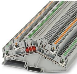
Morsetto sezionatore, Corrente e tensione sono determinate dalla spina impiegata., A due piani con profilo obliquo, un sezionatore a coltello e un punto di sezionamento, tensione nominale: 400 V, corrente nominale: 16 A, 1. e 2. piano, tipo di connessione: Connessione Push-in, Sezione di dimensionamento: 2,5 mm<sup>2</sup>, sezione: 0,14 mm<sup>2</sup> - 4 mm<sup>2</sup>, montaggio: NS 35/7,5, NS 35/15, colore: grigio
