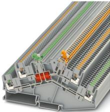
Morsetto con sezionatore a coltello, a due piani con profilo obliquo e due sezionatori a coltello, tensione nominale: 400 V, corrente nominale: 16 A, 1. e 2. piano, tipo di connessione: Connessione Push-in, Sezione di dimensionamento: 2,5 mm<sup>2</sup>, sezione: 0,14 mm<sup>2</sup> - 4 mm<sup>2</sup>, montaggio: NS 35/7,5, NS 35/15, colore: grigio
