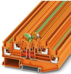
Morsetto con sezionatore a coltello, tensione nominale: 400 V, corrente nominale: 16 A, 1. e 2. piano, tipo di connessione: Connessione Push-in, Sezione di dimensionamento: 2,5 mm<sup>2</sup>, sezione: 0,14 mm<sup>2</sup> - 4 mm<sup>2</sup>, montaggio: NS 35/7,5, NS 35/15, colore: arancione
