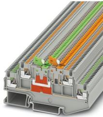
Morsetto con sezionatore a coltello, tensione nominale: 400 V, corrente nominale: 9 A, 1. e 2. piano, tipo di connessione: Connessione Push-in, Sezione di dimensionamento: 1,5 mm<sup>2</sup>, sezione: 0,14 mm<sup>2</sup> - 1,5 mm<sup>2</sup>, montaggio: NS 35/7,5, NS 35/15, colore: grigio
