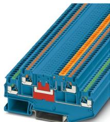
Morsetto con sezionatore a coltello, tensione nominale: 400 V, corrente nominale: 9 A, 1. e 2. piano, tipo di connessione: Connessione Push-in, Sezione di dimensionamento: 1,5 mm<sup>2</sup>, sezione: 0,14 mm<sup>2</sup> - 1,5 mm<sup>2</sup>, montaggio: NS 35/7,5, NS 35/15, colore: blu
