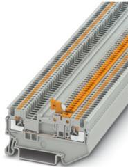
Morsetto con sezionatore a coltello, tensione nominale: 400 V, corrente nominale: 10 A, 1. piano, tipo di connessione: Connessione Push-in, Sezione di dimensionamento: 1,5 mm<sup>2</sup>, sezione: 0,14 mm<sup>2</sup> - 1,5 mm<sup>2</sup>, montaggio: NS 35/7,5, NS 35/15, colore: grigio
