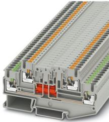
Morsetto passante, tensione nominale: 400 V, corrente nominale: 16 A, tipo di connessione: Connessione Push-in, 1. e 2. piano, Sezione di dimensionamento: 2,5 mm<sup>2</sup>, sezione: 0,14 mm<sup>2</sup> - 4 mm<sup>2</sup>, tipo di montaggio: NS 35/7,5, NS 35/15, colore: grigio
