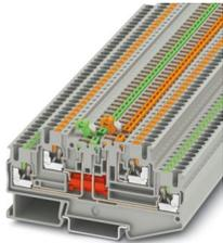
Morsetto con sezionatore a coltello, tensione nominale: 400 V, corrente nominale: 16 A, 1. e 2. piano, tipo di connessione: Connessione Push-in, Sezione di dimensionamento: 2,5 mm<sup>2</sup>, sezione: 0,14 mm<sup>2</sup> - 4 mm<sup>2</sup>, montaggio: NS 35/7,5, NS 35/15, colore: grigio
