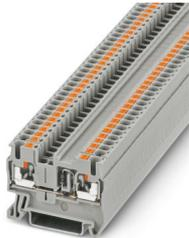
Componente morsetto componibile. La corrente massima è determinata dal diodo. Integrato: diodo 1N 4007, tensione di blocco: 1300V, corrente limite permanente: 0,5A., con diodo integrato 1N4007, corrente nominale: 0,5 A, tipo di connessione: Connessione Push-in, Sezione di dimensionamento: 2,5 mm<sup>2</sup>, sezione: 0,14 mm<sup>2</sup> - 4 mm<sup>2</sup>, montaggio: NS 35/7,5, NS 35/15, colore: grigio
