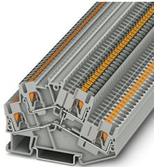
Morsetto a due piani, con ripartitore di potenziale, tensione nominale: 500 V, corrente nominale: 22 A, tipo di connessione: Connessione Push-in, 1. piano, Sezione di dimensionamento: 2,5 mm<sup>2</sup>, sezione: 0,14 mm<sup>2</sup> - 4 mm<sup>2</sup>, tipo di montaggio: NS 35/7,5, NS 35/15, colore: grigio
