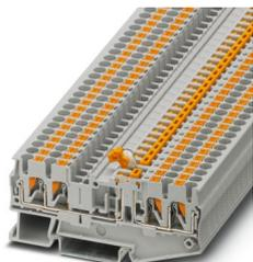
Morsetto con sezionatore a coltello, tensione nominale: 400 V, corrente nominale: 20 A, tipo di connessione: Connessione Push-in, Sezione di dimensionamento: 2,5 mm<sup>2</sup>, sezione: 0,14 mm<sup>2</sup> - 4 mm<sup>2</sup>, montaggio: NS 35/7,5, NS 35/15, colore: grigio
