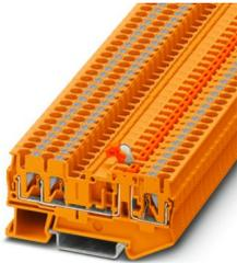
Morsetto con sezionatore a coltello, tensione nominale: 400 V, corrente nominale: 20 A, tipo di connessione: Connessione Push-in, Sezione di dimensionamento: 2,5 mm<sup>2</sup>, sezione: 0,14 mm<sup>2</sup> - 4 mm<sup>2</sup>, montaggio: NS 35/7,5, NS 35/15, colore: arancione
